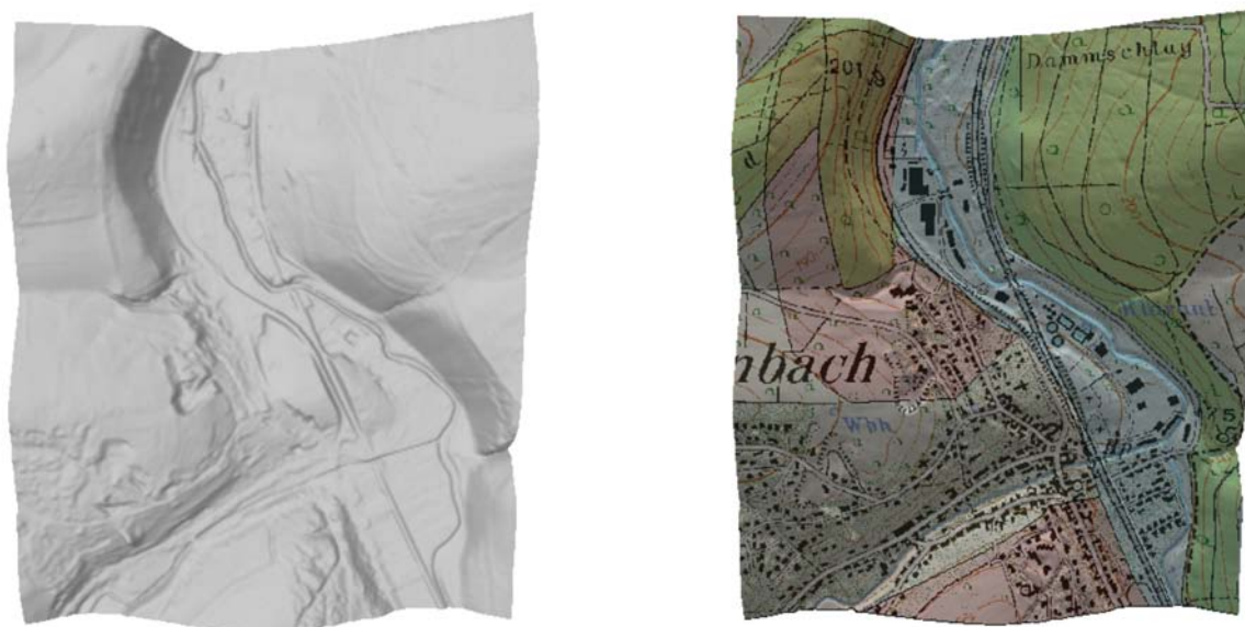
Abbildung 7.7: Geländeoberfläche ohne (links) und mit Textur (rechts)
