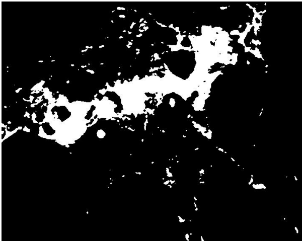
Abbildung 4.10: Binäre Abbildung der Porenstruktur des Al0104T bei einer Vergrößerung von 1:1000.
