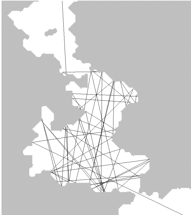
Abbildung 7.10: Trajektorie eines Teilchens in einem stark vergrößerten Ausschnitt der zweidimensionalen Textur des porösen Filtermaterials GMA-EDMA.
