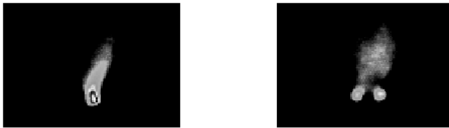
Abbildung 3-13: Demonstration eines schaltbaren Beamsplitters durch Ansteuerung des 8-Draht-Leiters wie im Text beschrieben.
