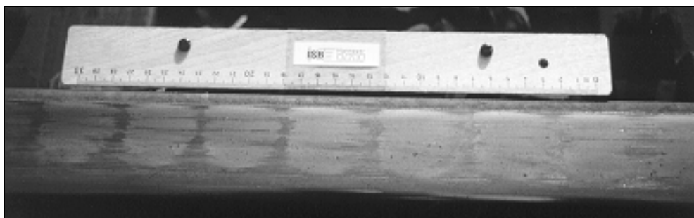
Bild 2.11: Schlupfwellen auf einer Innenbogenschiene
