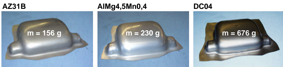
Bild 7.10: Tiefziehteile aus unterschiedlichen Blechwerkstoffen; s_0 = 1,0 mm /Dröder99b/
