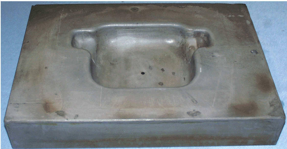
Bild 7.7: Kunststoffmatrize aus temperaturbeständigem Epoxidharz /Dröder99b/
