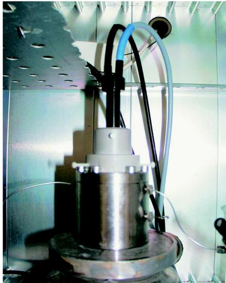
Abb. 13.6: Der Reaktor inkl. Lichtleiter und Fixieraufsatz [Knüttel; 1999]
