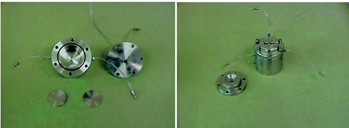
Abb. 13.5: Der Hochdruckreaktor
