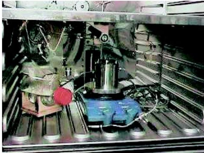
Abbildung 13.4: Darstellung des Reaktors mit integrierter Probenahme
