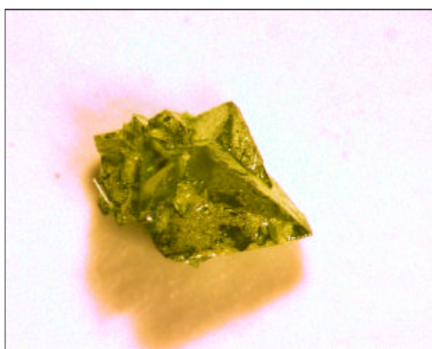
Abb. 10.1 Digitalkameraaufnahme eines Kristalls der Rutilmischphase (\text{Ti}_{0,66}\text{Ni}_{0,13}\text{Nb}_{0,21})\text{O}_2
