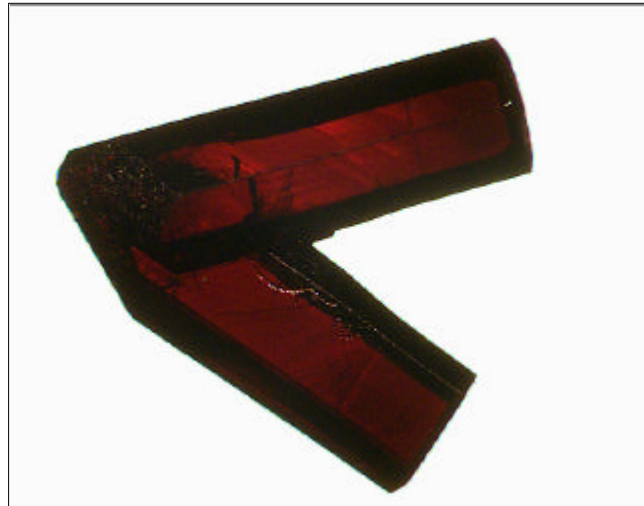
Abb. 8.9 Digitalkameraaufnahme eines ZnO(MnO)-Kristalls
