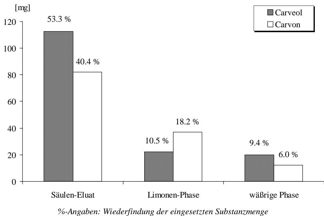
Abb. 2-91: Wiederfindung des Substrates und der Produkte im Säuleneluat, der Limonenphase und der wäßrigen Phase
