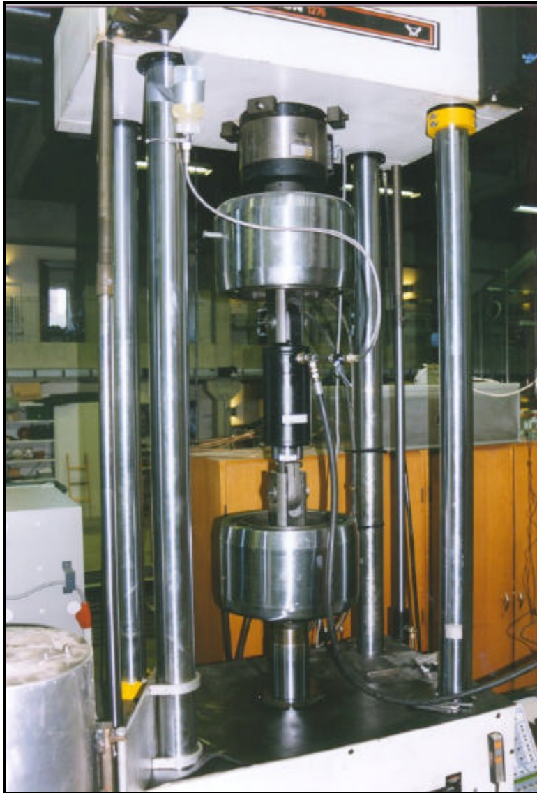
Abb. 7.6: Prüfmaschine mit Druckzylinder
