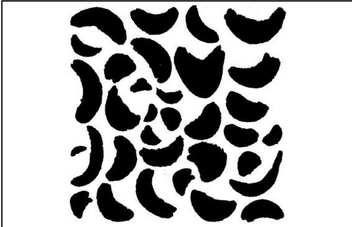
Abb. 8.24: Typische Faserquerschnittsformen (FeCrAl, Faserquerschnitte sind schwarz dargestellt).
